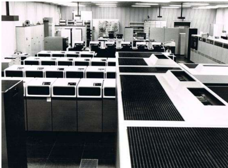
Store haller hos SDC i Ballerup med faste diske (datalagre), f.eks. IBM 3380, CDC eller Memorex
