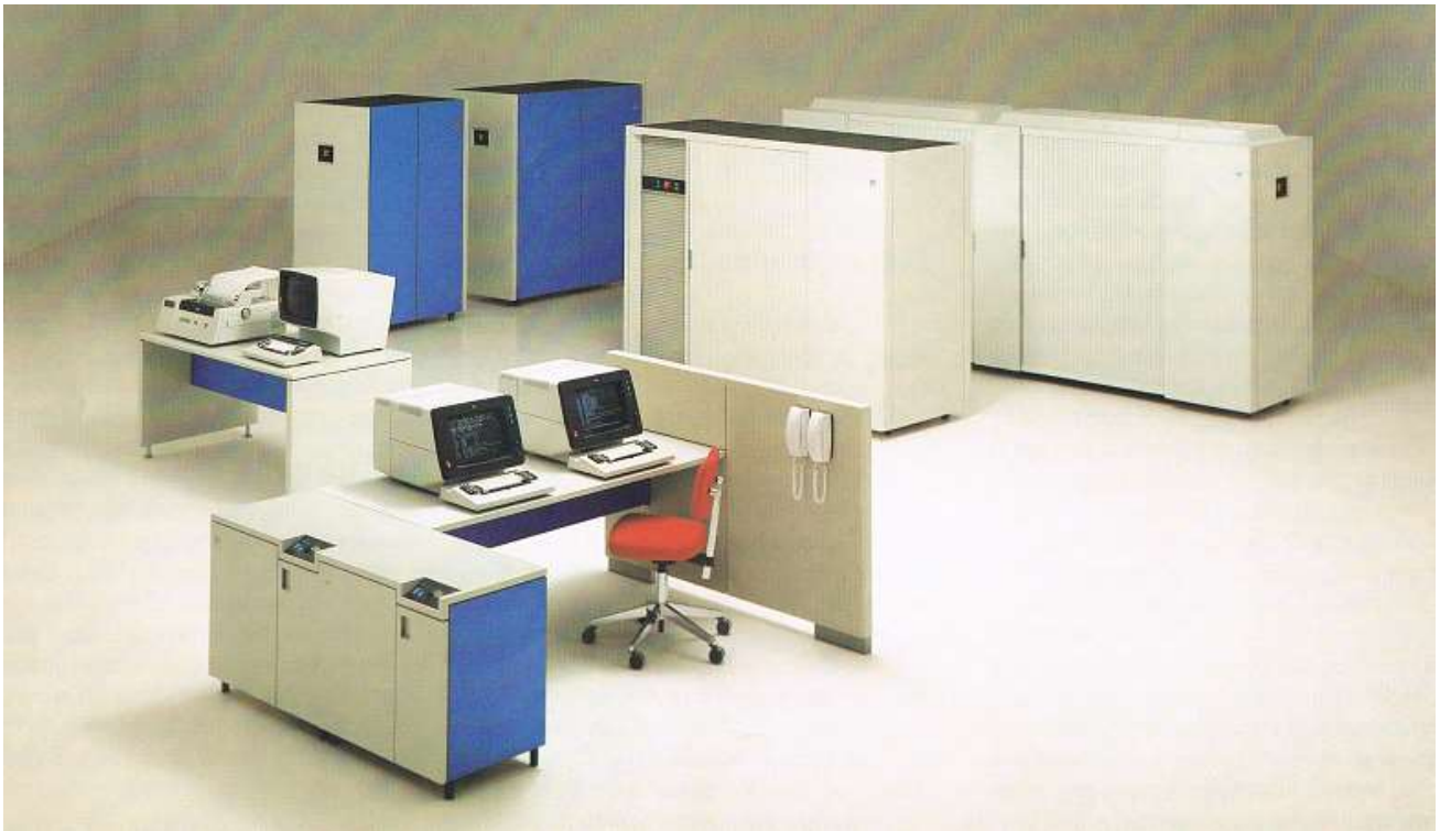
IBM Centralenhed 3081 – fra 1981 – vandkølet elektronik
