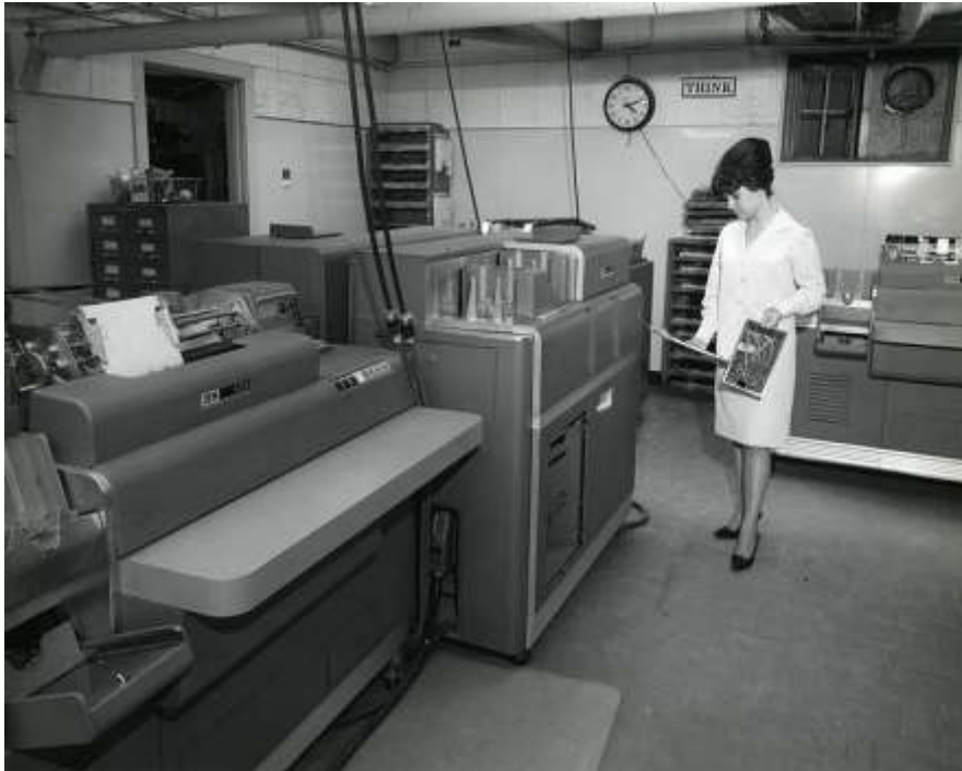
Hulkortafdeling anno 1953 med en tabulator og en IBM 519 reproducer
