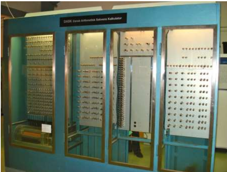
Bygget op med radorør
